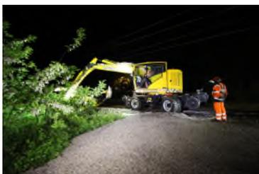
Les débroussailleuses traitent habituellement une bande de 4 mètres de chaque côté des voies. Elles peuvent entretenir environ 1 kilomètre de végétation par nuit de travaux.
